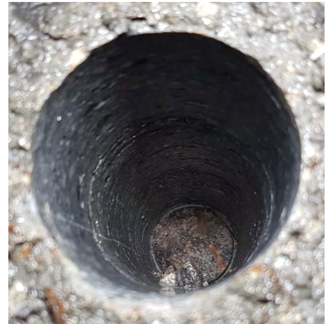
Станок колонкового бурения достиг породы, и керн сломался в месте контакта.
